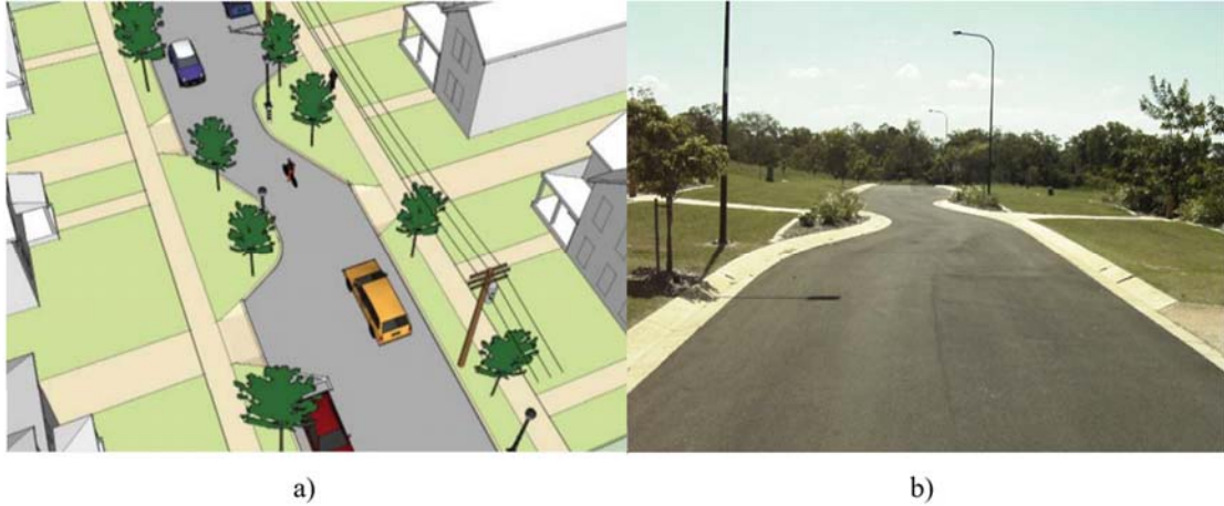
Şekil 2. a) Kıvrımlamalara ait bir 3B çizim örneği ve b) gerçek bir uygulama [7, 8]. ((a) A 3D drawing chicane example and (b) a real site application [7, 8].)
