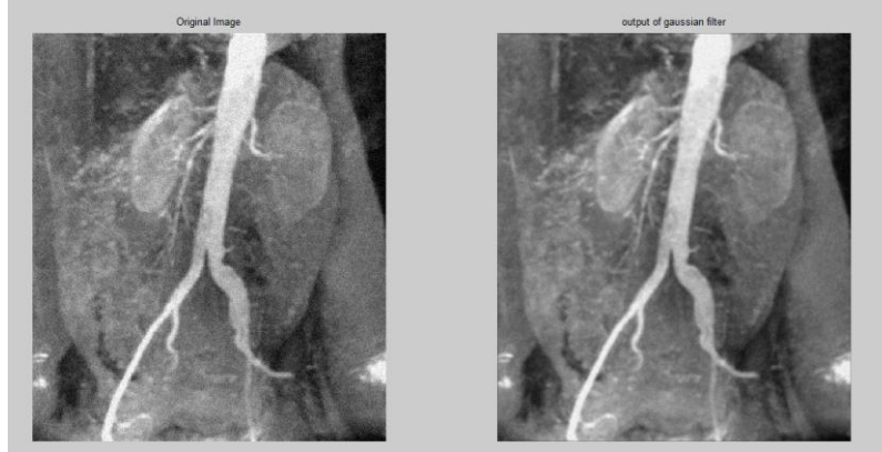
Şekil 8. Görüntünün Orijinal Hali, Gauss Filtresinden Geçirildikten Sonraki Hali
