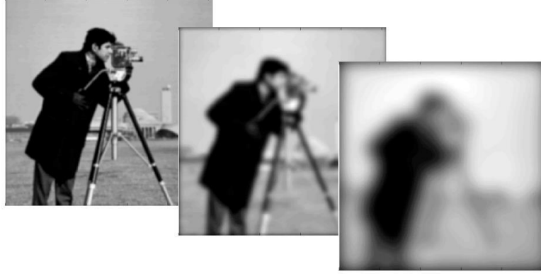
Şekil 7. Değişik \Sigma Değerlerinin Gauss Filtresi Üzerindeki Etkisi
