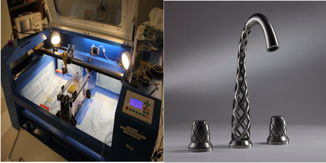
Görsel 4,5. SLS baskı teknolojisi ve SLS ile üretilmiş ürün
